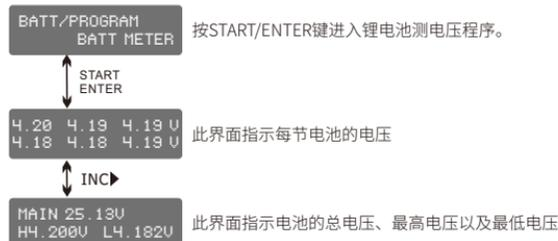
用户可以检测到电池总电阻、最高电阻、最低电阻以及每节电池的电阻。请将电池连接到充电器，主电池连接至电池接口，并且用平衡线连接平衡接口。
